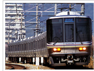
電力回生ブレーキを利用した223系車両
